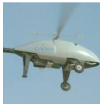
Apid 55 är 3,1 meter lång och väger 160 kilo med full tank och maxlast av instrument. Motorn är tvåcylindrig på 55 hk.
