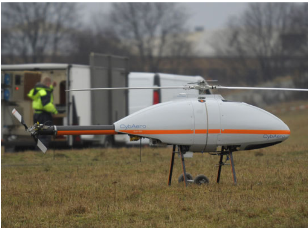
Den lilla helikoptern Apid55 är utvecklad av CybAero i Linköping. Helikoptern ska bland annat användas för övervakning och inspektion av elledningar.
